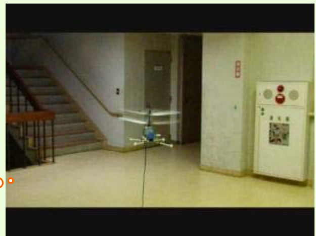
図 R/Cヘリコプタの自律制御(ホバリング)
