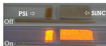
紫外光源 (波長365 nm) による照射をOff(上) / On(下)時のナノシリコンパウダーの写真
