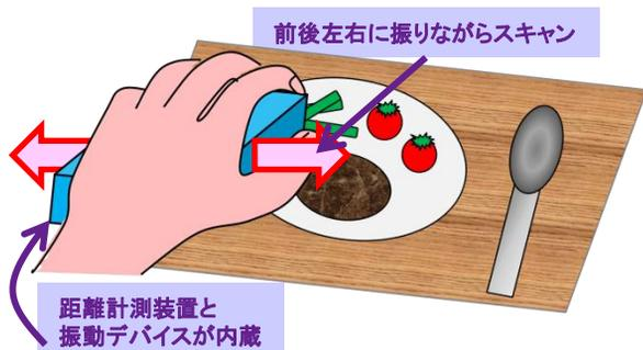
**目の不自由な方**用のデバイスで, 距離を振動に変換する機器を手に持って卓上をスキャンすることで**物体を認識**します。
